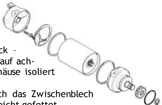
Das Getriebe, die Durchführung des Läufers durch das Zwischenblech und den Lagerzapfen auf der Kohlenseite werden leicht gefettet.
