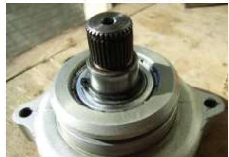
Für die Reinigung eignet sich eine große Flasche Bremsenreiniger am Besten. Besonders vorsichtig sollte man beim Anker sein. Die Wicklung ist Lackisiert und darf nicht beschädigt werden. Am Besten reinigen und dann in einem Tuch eingewickelt zu Seite legen.
