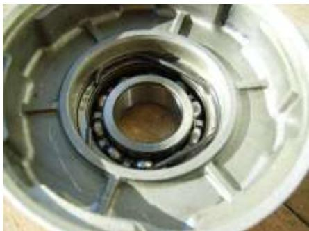
Die Wellendichtung vorsichtig aus dem Anlasserkopf herausnehmen. Aufpassen das dabei nicht der Zentrierrand des Anlassers beschädigt wird. Die Dichtung kann nicht mit dem Lager herausgepresst bzw. -geschlagen werden, weil das Lager mit einer Feder gesichert ist. Wenn die Dichtung heraus ist, kann man die Feder sehen. Soll auch das Lager erneuert werden, muss die Sicherungsfeder herausgenommen werden. Dann kann das Lager herausgepresst oder -geschlagen werden
