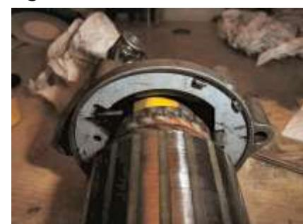
Dazu schneidet man ein Stück Schmirgelpapier mit 800er oder 1000er Körnung, das in etwa die doppelte Breite und die Länge des Umfangs des Kommutators hat. Das Papier faltet man einmal in der Mitte entlang der Längsachse, sodass die Schmirgelseiten außen sind. Dadurch rutscht das Schmirgelpapier auf dem Kommutator nicht und die Kohlen werden tatsächlich geschliffen.
