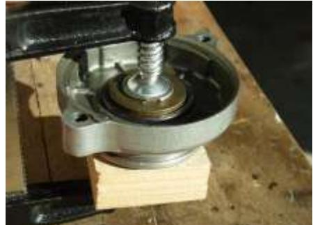
Die neue Wellendichtung (Simmering mit Feder) so einsetzen, dass die Feder zum Lager zeigt. Die Dichtung mit Feder ist 6 statt 5 mm dick und ragt daher etwas aus dem Sitz, was aber nicht weiter tragisch ist. Nach dem Einsetzen die Dichtlippe der Wellendichtung mit etwas Fett bestreichen.
